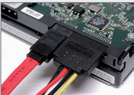
Жесткий диск с подключенным интерфейсом SATA.
